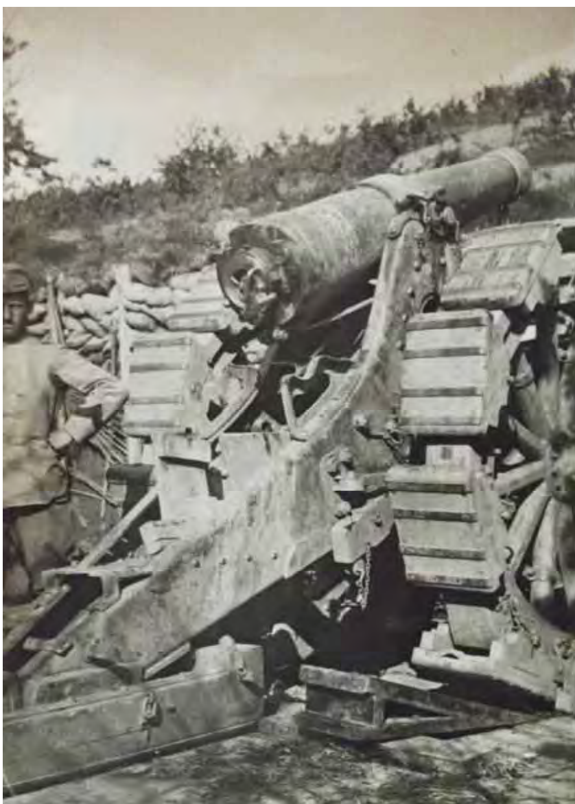
Cannone da 149G, simile a quello portato sull'Adamello, che fu tra i primi incarichi di mio zio. Notare la dimensione dell'affusto e i cingoli "Bonagente" aggiunti alle ruote del carriaggio per permettere un rotolamento più facile ( cioè meno difficile) sui terreni impervi o innevati.
