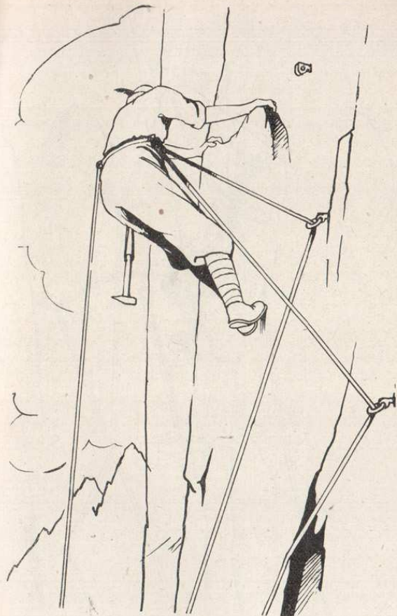
Fig. 28 - Assicurazione a forbice: particolare.
