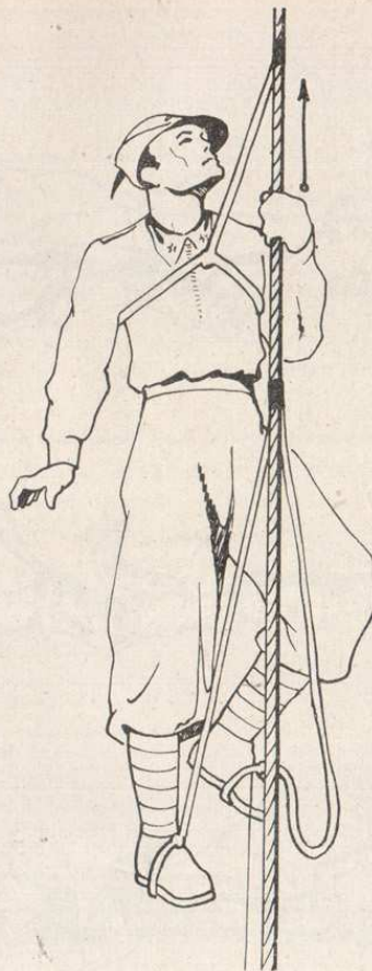
Fig. 30 - Salita alla corda con l'ausilio di staffe Prussik.
